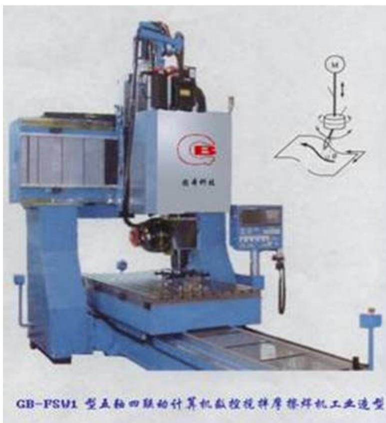
GB-FSW1 型五轴四联的计算机数控搅拌摩擦焊机工业造型
