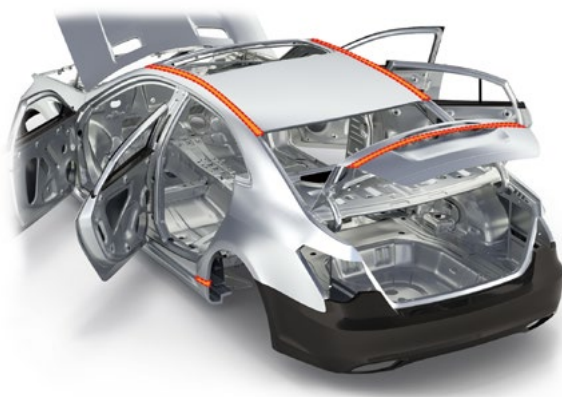
汽车制造中的“激光钎焊”应用部位示例
