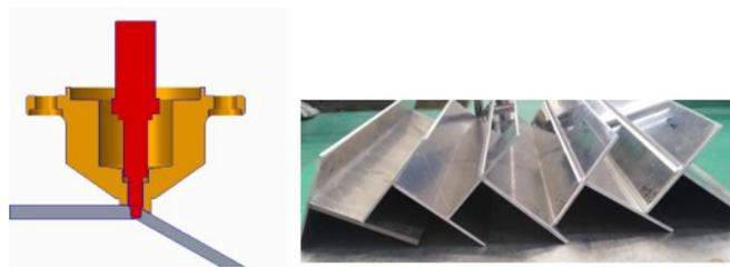
图 13 静止轴肩外角焊<sup>[117]</sup>
