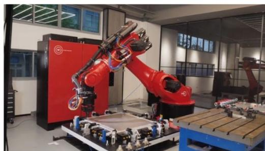
图28 搅拌摩擦焊机器人工作站
