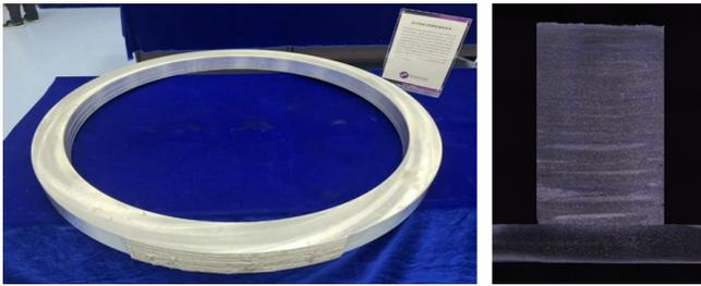
图 24 搅拌摩擦增材工程验证环件/剖面致密组织
